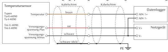
Maximale Leitungsverlängerung für Temperatursensoren mit 3-m-Anschlussleitung
